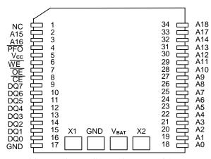
34-PIN POWERCAP MODULE BOARD (USES DS9034PCX POWERCAP)
