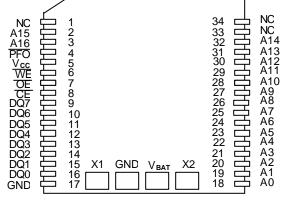
34-PIN POWERCAP MODULE BOARD (USES DS9034PCX POWERCAP)
