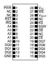
28-Pin ENCAPSULATED PACKAGE (720-mil FLUSH)
