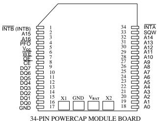
34-PIN POWERCAP MODULE BOARD (USES DS9034PCX POWERCAP)
