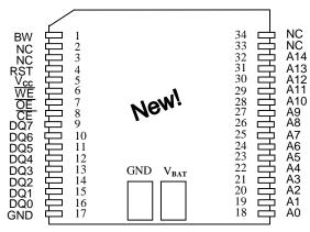
34-Pin POWERCAP MODULE (PCM) (USES DS9034PC POWERCAP)
