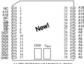
34-PIN POWERCAP MODULE (PCM) (USES DS9034PC POWERCAP)
