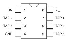
DS1100M 8-PIN DIP (300 MIL) DS1100Z 8-PIN SOIC (150 MIL) DS1100U 8-PIN MICRO-SOP
