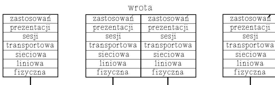
Rys. 6. Ilustracja zasady pracy wrot
